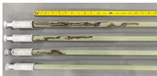
(b) 复合绝缘子内部导通性缺陷设置
